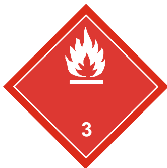
Пиктограмма легковоспламеняющейся жидкости, предусмотренная в Типовых правилах ООН (символ: пламя: черный или белый; фон: красный; цифра 3 в нижнем углу; минимальные размеры: 100 мм × 100 мм)
